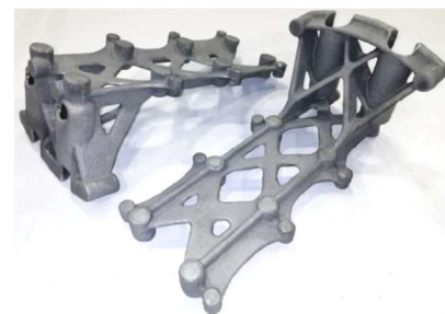
12(d) Ladderframe castings after shotblasting
