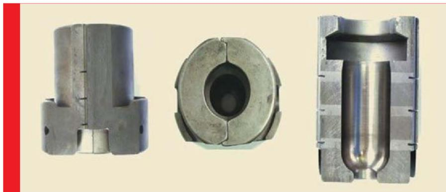
Fig. 13 – Molde para a produção de peças em vidro por sopra
