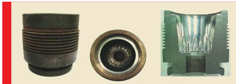
Fig. 10 – Molde para a produção de peças em vidro por prensagem
