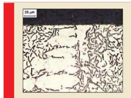
Fig. 14 – Microestrutura e superfície de trabalho do molde de ferro fundido cinzento com grafita do tipo D e matriz ferrítica (163 HB; ataque com nital)
