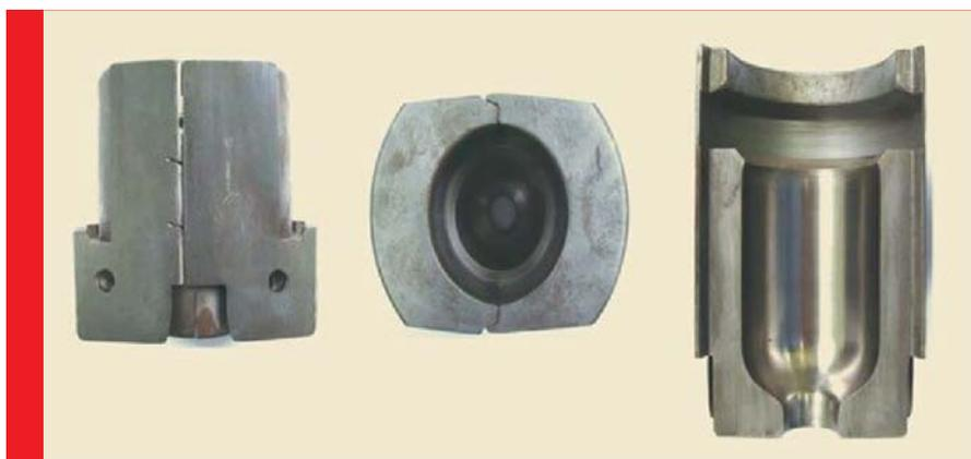
Fig. 16 – Molde utilizado na produção de peças em vidro por sopro
