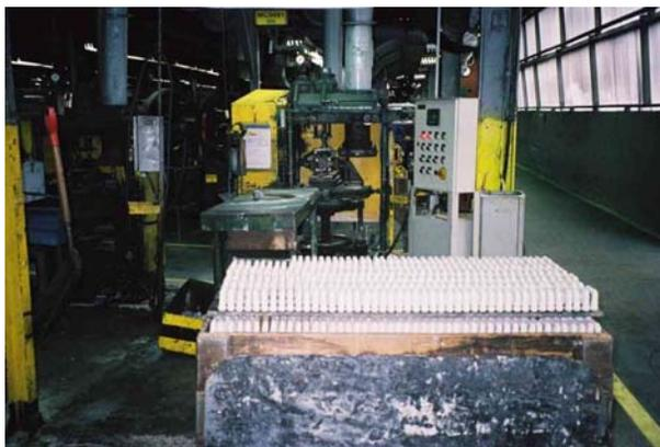
Figura 8 – Machos fabricados, em primeiro plano, com equipamento Osborn Cold Box<sup>®</sup>, ao fundo.
