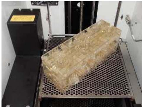
Figura 2 - Caixa de machos sobre a plataforma do equipamento de estereolitografia, após a construção.
