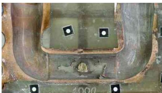
Figura 13 – Detalhe do descolamento do recobrimento de cobre junto à saída de gases.
