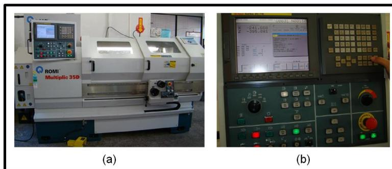
Figura 7 – Máquina-ferramenta utilizada nos ensaios de torneamento; (a) Torno Romi CNC, modelo Multiplic 35D; (b) Pannel equipado com comando numérico GE FANUC Series 21i – TB
